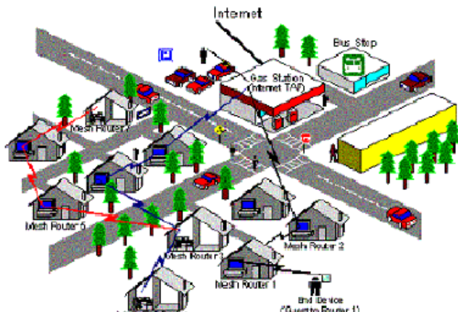
Rys. 6. Koncepcja sieci kratowej. Poszczególne komputery (terminale) działają jako nadajniki, odbiorniki lub przekaźniki sygnałów. W ten sposób przeszkody propagacyjne mogą być „omijane”. (wg. Microsoft)
